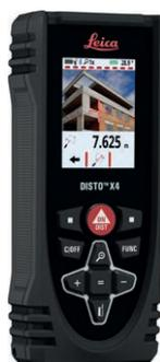
Der DISTO X4 ist im Vergleich mit dem DISTO X3 mit einer Zielsucherkamera ausgestattet. Diese ermöglicht es, den Laserpunkt des DISTO Gerätes über das hochauflösende, vollfarbige Display auszurichten: richten Sie einfach den gewünschten Messpunkt im auf dem Display erscheinenden Fadenkreuz aus und erhalten Sie so eine genaue Messung.
