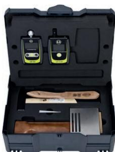
Komplett ausgestattet zur Prüfung des Unterbodens und für sämtliche Feuchteprüfungen zur Vorbereitung der CCM-Messung
