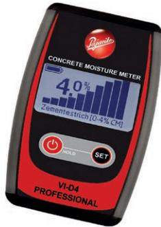
Für die Benutzung bei Feuchtigkeitsmessungen von Untergründen ausgelegt. Zerstörungsfreies Feuchtmessverfahren bei gleichzeitiger Aufrechterhaltung einer hohen Genauigkeit des Messergebnisses. Einfache Handhabung des Gerätes, Echtzeitanzeige der Messwerte auf dem gut ablesbaren Display, geeignet für die Vorprüfung der Belegreife von Baustoffen bei CM-Messungen.
