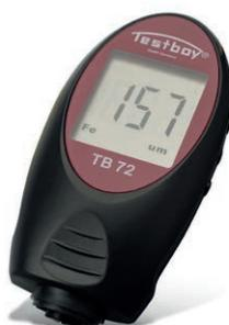
Robustes Kunststoffgehäuse, UV-beständig und spritzwassergeschützt. Misst alle nicht magnetischen Schichten wie Lacke, Kunststoffe, Emaille... auf nicht-magnetischem, metallischem Untergrund (zB Aluminium, Kupfer,...) Das Umschalten der Kombisonde für unterschiedliche Untergründe erfolgt automatisch. Der integrierte Messwertspeicher speichert die letzten 10 Messwerte. Messgenauigkeit:  $\pm 2\mu\text{m}$  (+3%),  $\pm 0,1\text{mil}$  (+3%)
